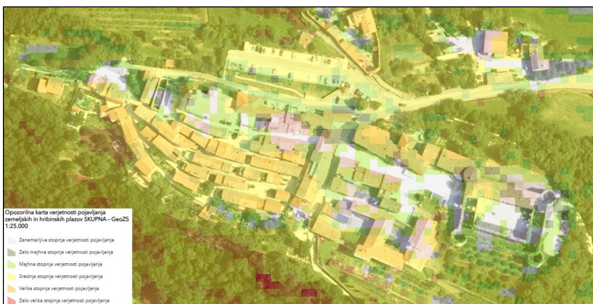
Slika 8: Obravnavano območje na Opozorilni karti verjetnosti pojavljanja zemeljskih in hribskih plazov (Atlas voda). Lokacija se nahaja na območju z zanemarljivo (0) in do veliko (4) stopnjo verjetnosti pojavljanja.
