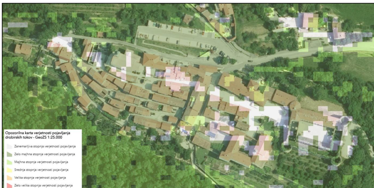
Slika 11: Obravnavano območje na Opozorilni karti verjetnosti pojavljanja drobirskih tokov (Atlas voda). Lokacija se nahaja na območju z zanemarljivo, zelo majhno (1) do majhno (2) stopnjo verjetnosti pojavljanja.
