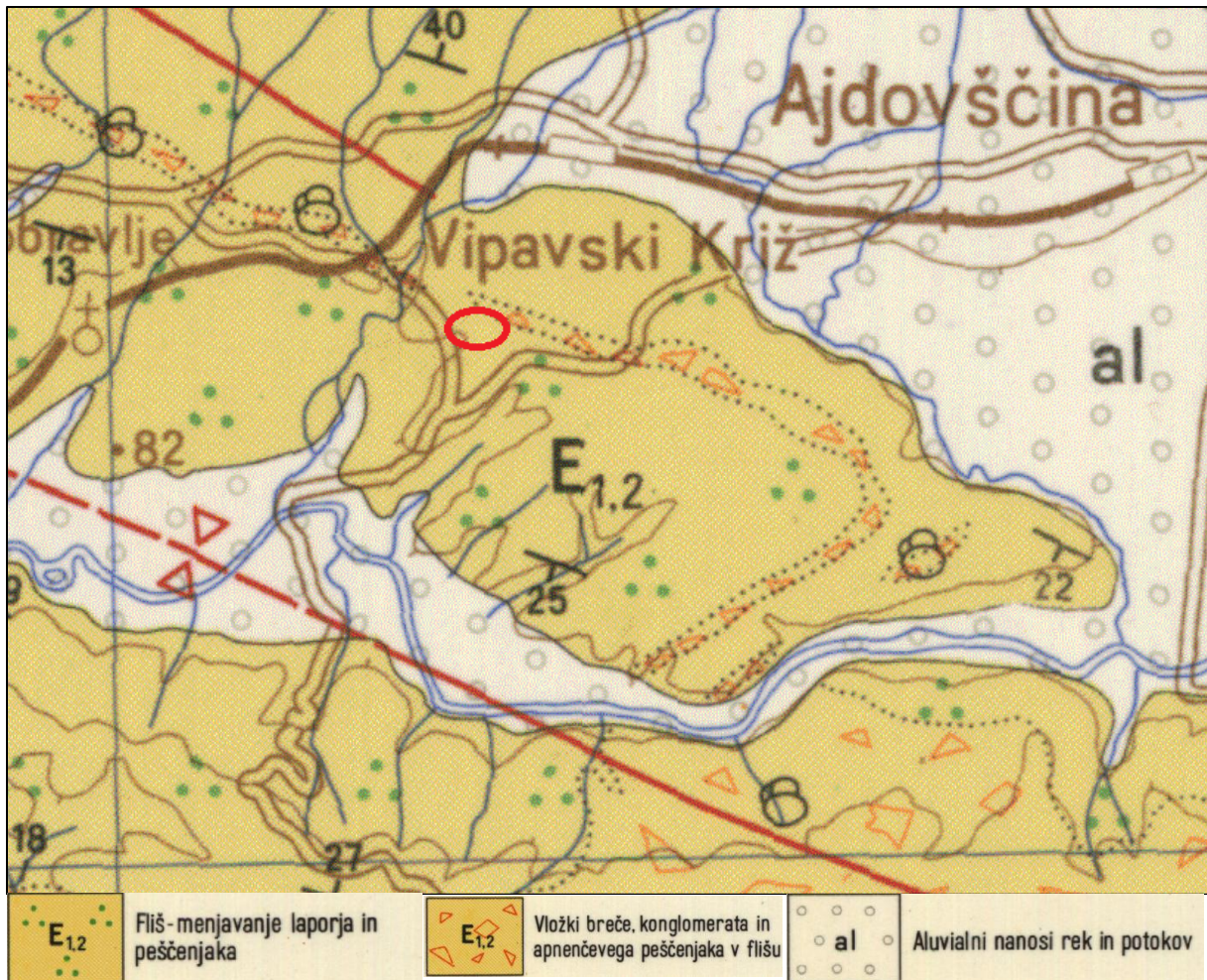
Slika 5: Obravnavana lokacija na Osnovni geološki karti 1 : 100.000, list Gorica (Buser, 1968). Legenda: E 1,2 – Fliš-menjavanje laporja in peščenjaka (terciar), E 1,2 – Vložki breče, konglomerata in apnenčevega peščenjaka-Planinska breča, al – aluvialni nanosi rek in potokov (kvartar).
