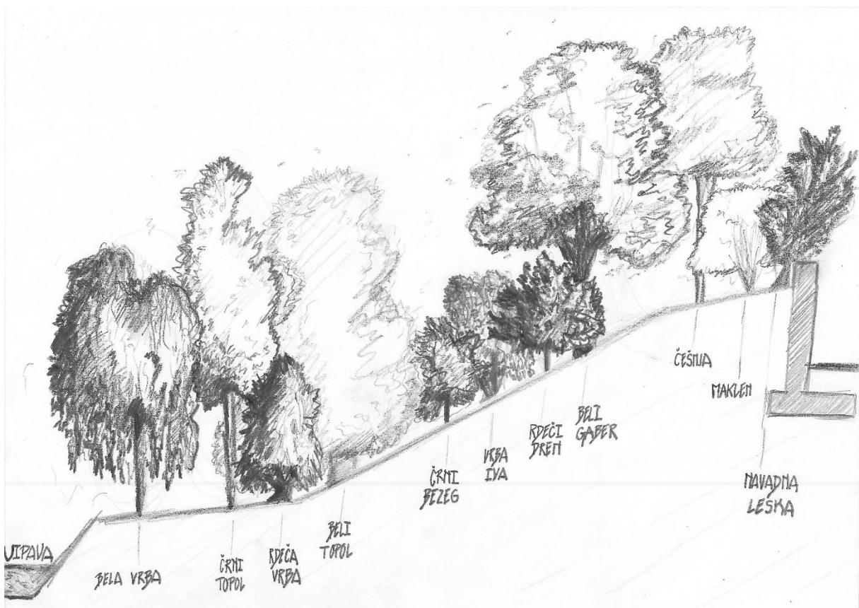
Slika 32: Shematski prikaz predlaganih drevesnih in grmovnih vrst in njihove možne razporeditve po nasipu glede na vodni režim, kjer so kombinacije poljubne za 1,2-2m pas (lahko se zasadi le 2-3 od možnih vrst), odvisno od posameznih razmer vzdolž novega podpornega AB zidu.
