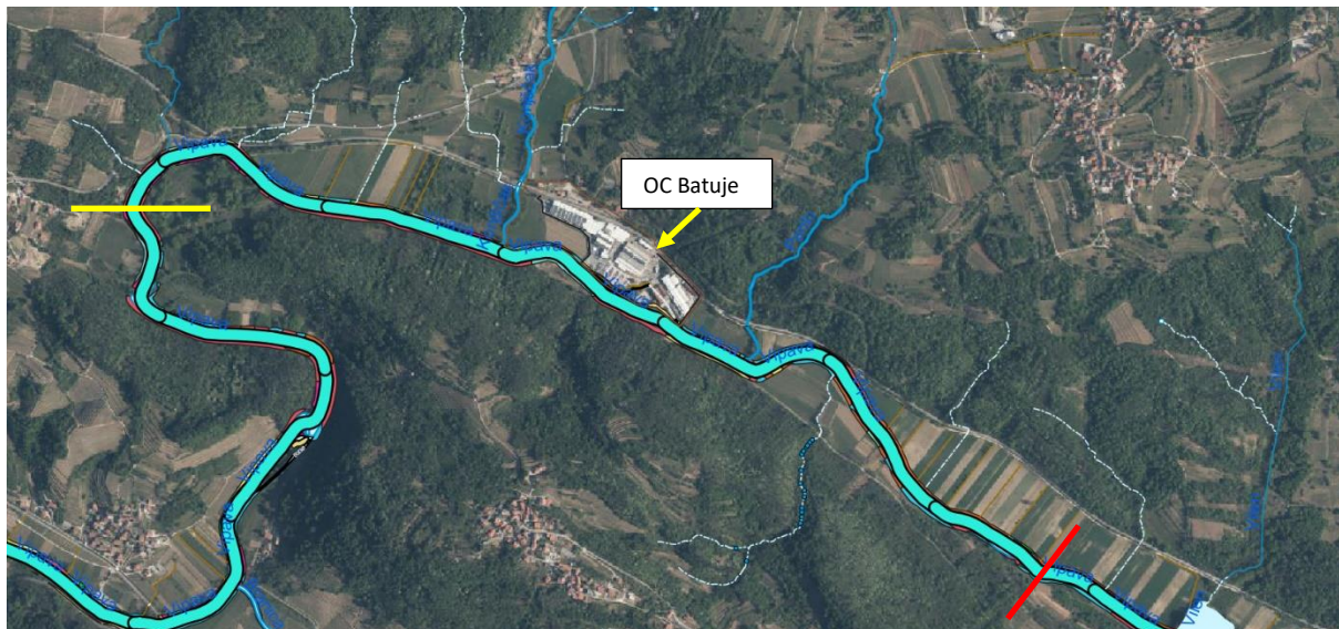
Slika 2: Vplivno območje izgradnje podpornih zidov za zaščito IOC Batuje. Rdeča linija prikazuje gorvodno in rumena linija dolvodno mejo vplivnega območja.
