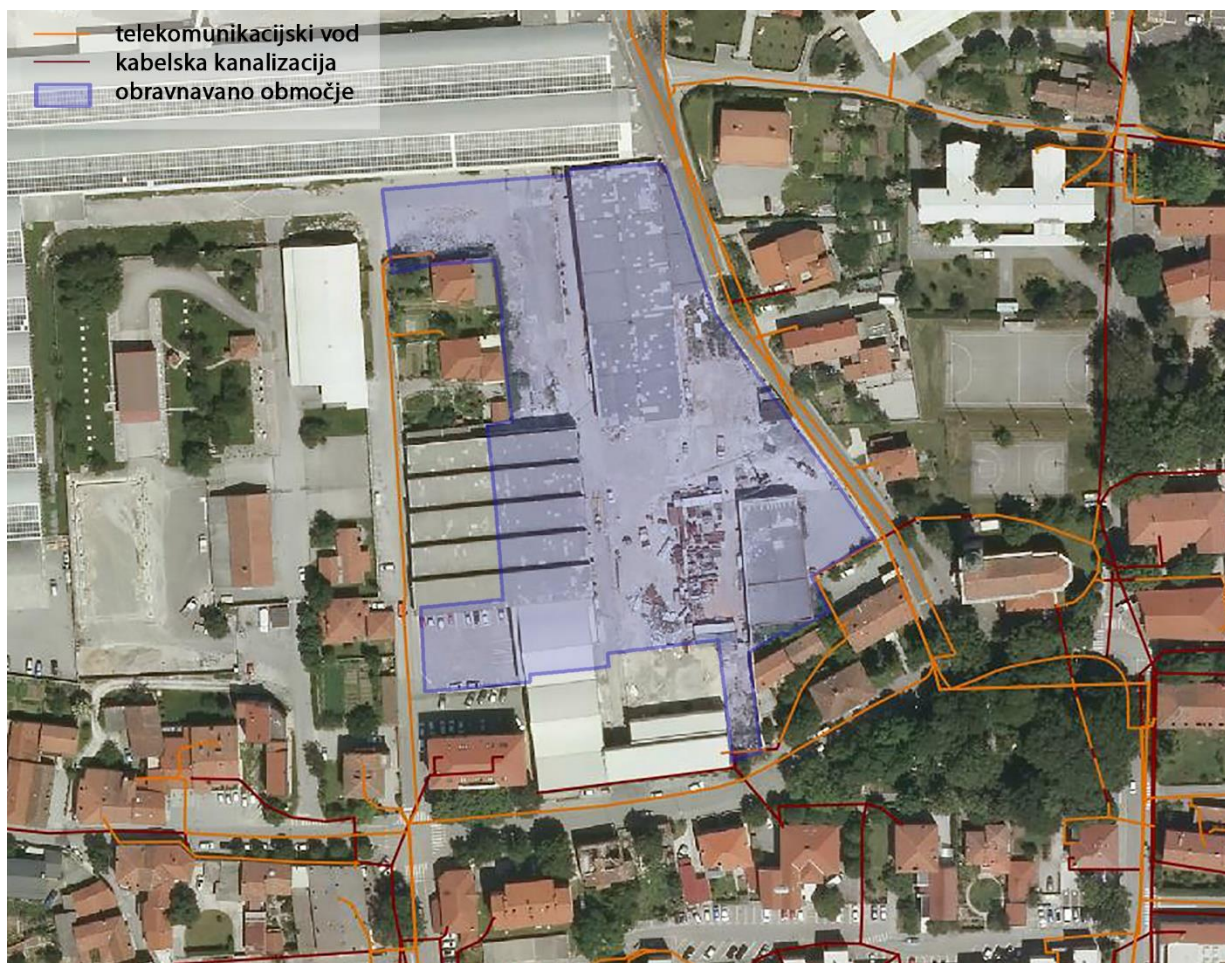
Slika 9: Telekomunikacijska infrastruktura, vir: https://gis.iobcina.si/gisapp/Default.aspx?a=ajdovscina
