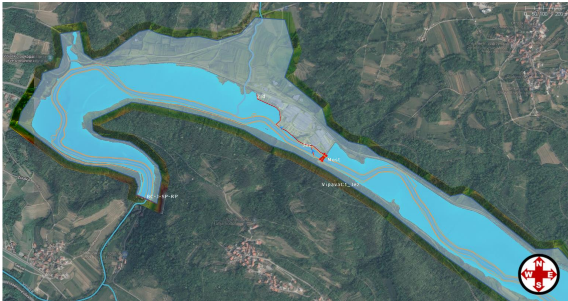
Slika 25: Prikaz hidravličnega modela za novo stanje
