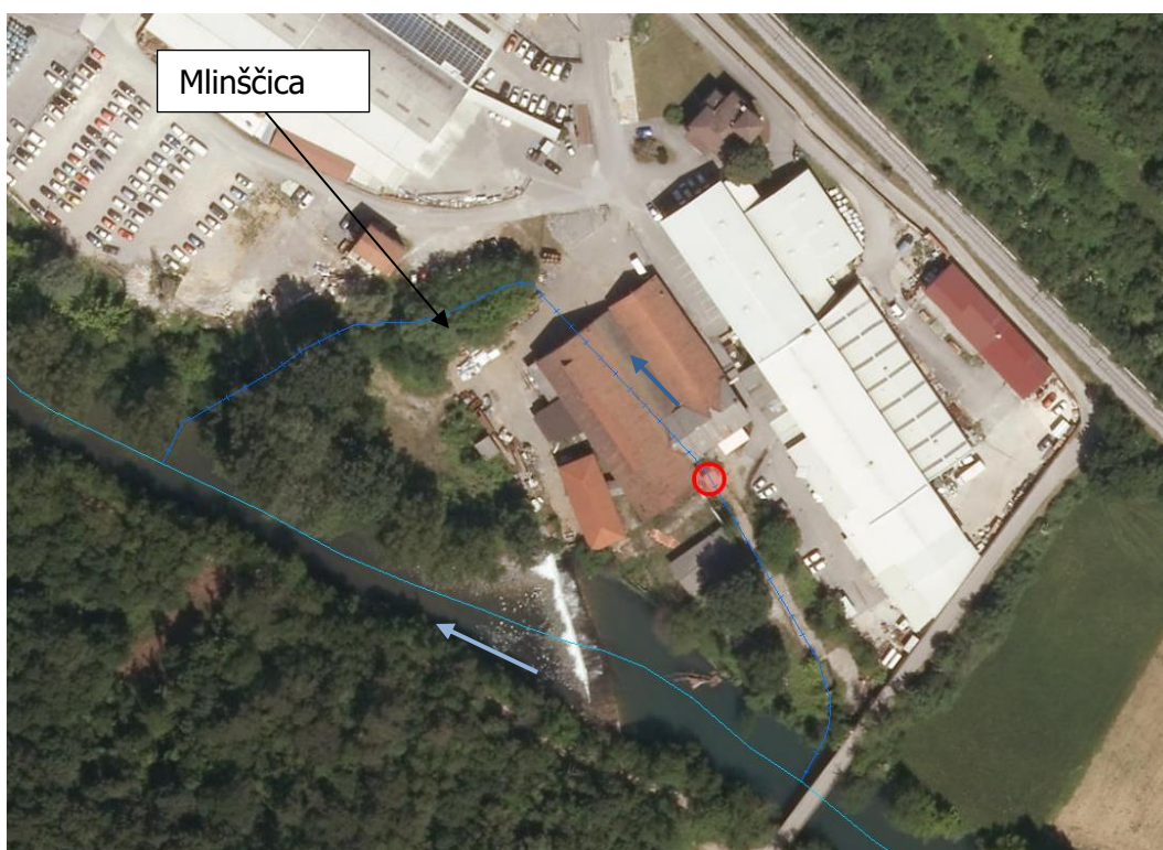
Slika 6: Lokacija znotraj IOC Batuje (rdeč krog), kjer je bilo 17.5.2021 5 cm vode, to je na koti 66,70 m.n.v, z označbo mlinščice (temno modra črta) (vir: ARSO)
