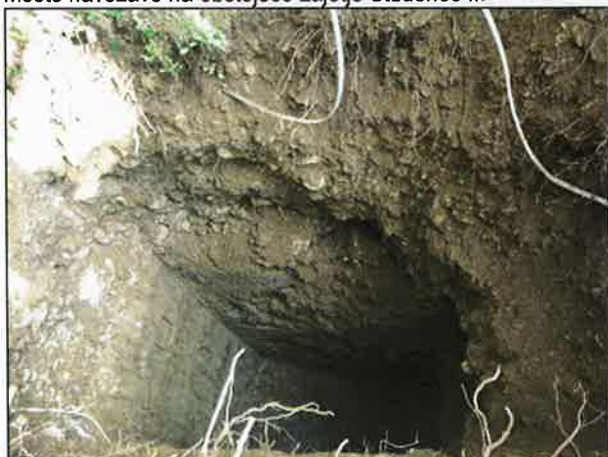
Sondažni razkop R1; zgoraj grušč z meljem, spodaj meljna glina, v podlagi preperel fliš.
