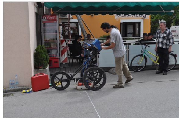
Slika 3. Meritve z georadarjem GSSI SIR3000 (400 MHz antena) na različnih območjih z različno sestavo površja.
