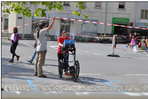
Slika 3. Meritve z georadarjem GSSI SIR3000 (400 MHz antena) na različnih območjih z različno sestavo površja.
