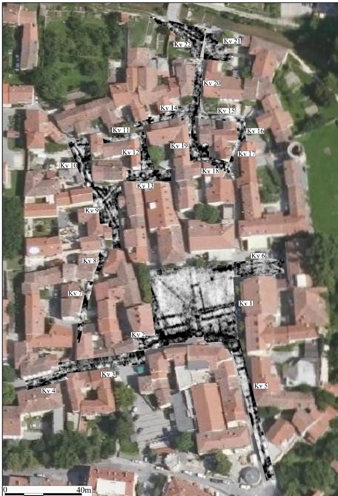
Slika 9. Rezultati georadarske metode za vse raziskane površine na globinskem intervalu cca. 1-2 m. Večina horizontalnih rezov je bila izbrana za globinski interval 1,3-1,6 m. Izraziti georadarski odboji, ki so posledica arheoloških arhitekturnih ostalin in podzemnih vodov so prikazani v temnejših odtenkih.
