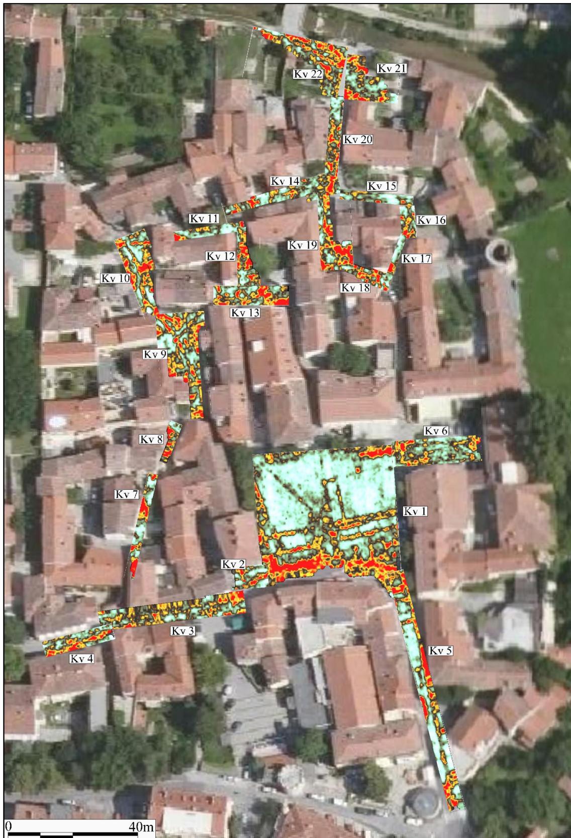
Slika 10. Rezultati georadarske metode za vse raziskane površine na globinskem intervalu cca. 1-2 m. Večina horizontalnih rezov je bila izbrana za globinski interval 1,3-1,6 m. Izraziti georadarski odboji, ki so posledica arheoloških arhitekturnih ostalin in podzemnih vodov so prikazani v rdeči in rumeni barvi.
