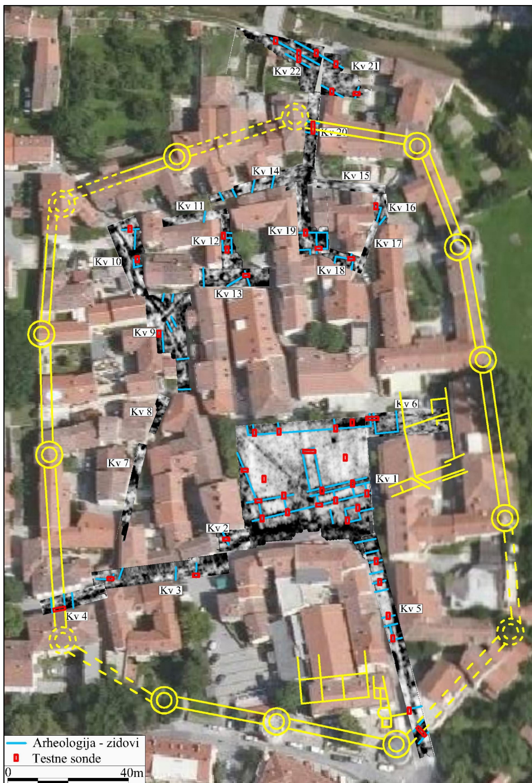
Slika A1. Rezultati georadarske metode na aerofotografiji s potekom obzidja in rezultati arheoloških izkopavanj v preteklosti z interpretacijo zidov Castre na podlagi rezultatov georadarske raziskave (vir arheoloških podatkov: Vodnik po razstavi, Zgodovina raziskav Castre, Betka Žbona Trkman s sodelavci). Označeni so položaji testnih sond na podlagi rezultatov georadarske raziskave.
