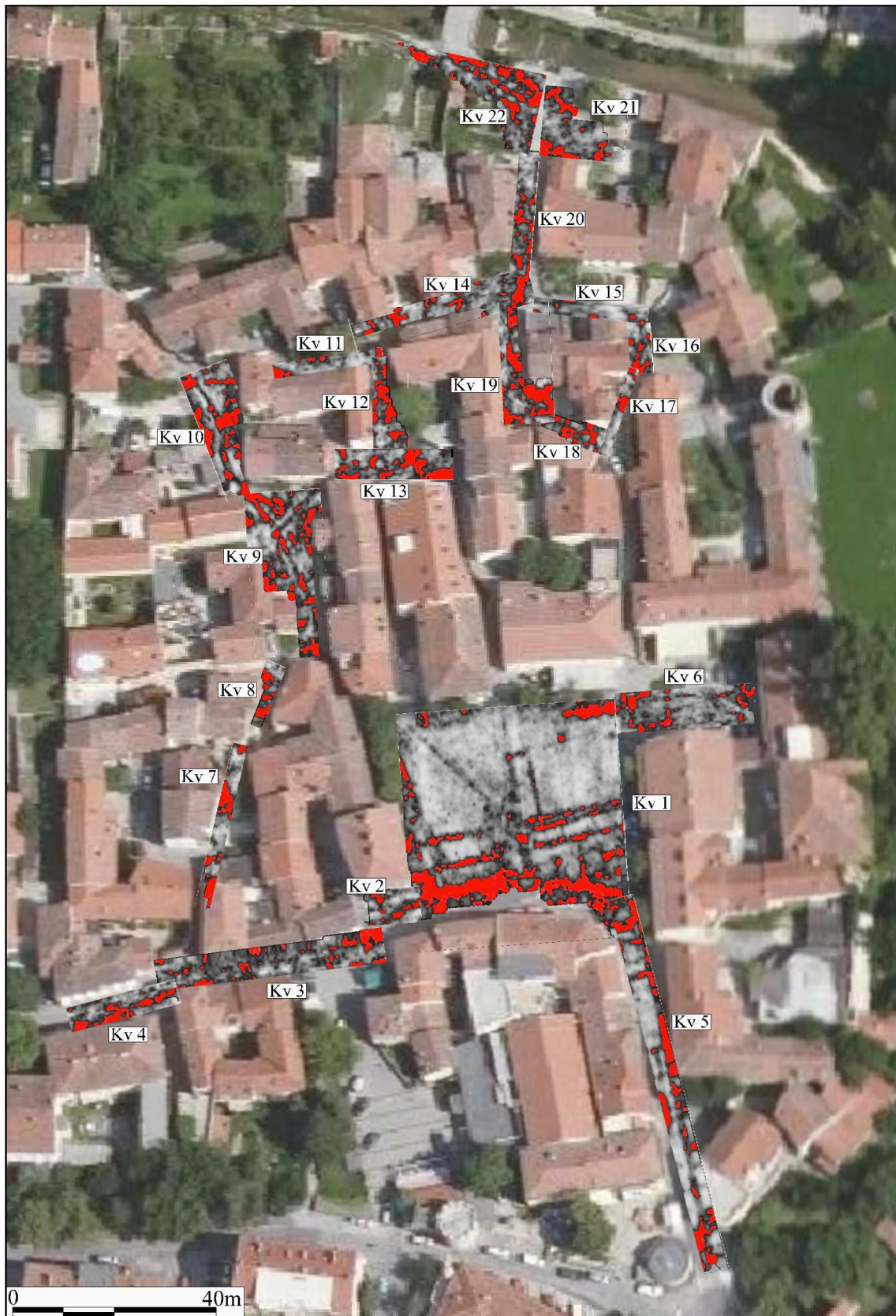
Slika 11. Rezultati georadske metode za vse raziskane površine na globinskem intervalu cca. 1-2 m. Večina horizontalnih rezov je bila izbrana za globinski interval 1,3-1,6 m. Izraziti georadrski odboji, ki so posledica arheoloških arhitekturnih ostalin in podzemnih vodov so prikazani v rdeči barvi.
