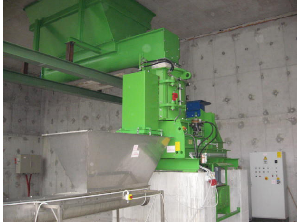
Ciklonski mlin vgrajen v spodnji (pritlični) del objekta za sprejem ločeno zbranih frakcij odpadkov iz gospodinjstev.
