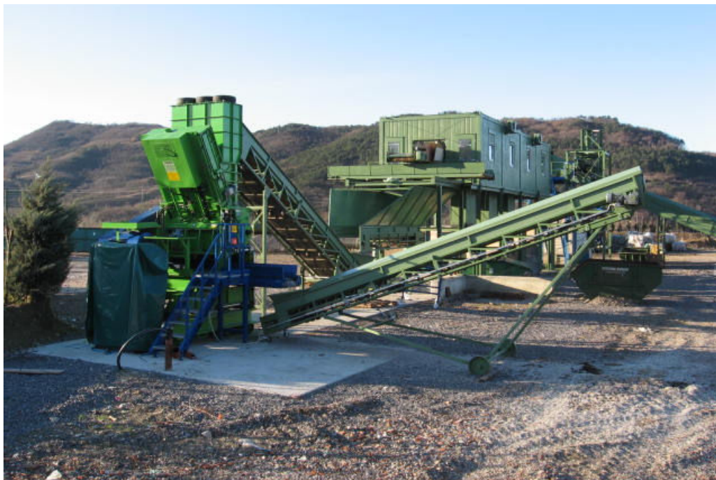
Montiran granulator s pripadajočimi transporterji.
