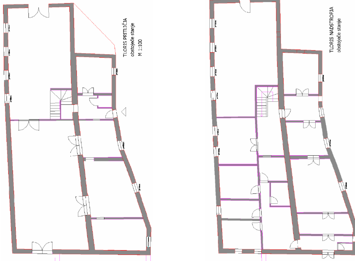
Slika 3: Tlorisi obstoječega objekta.
