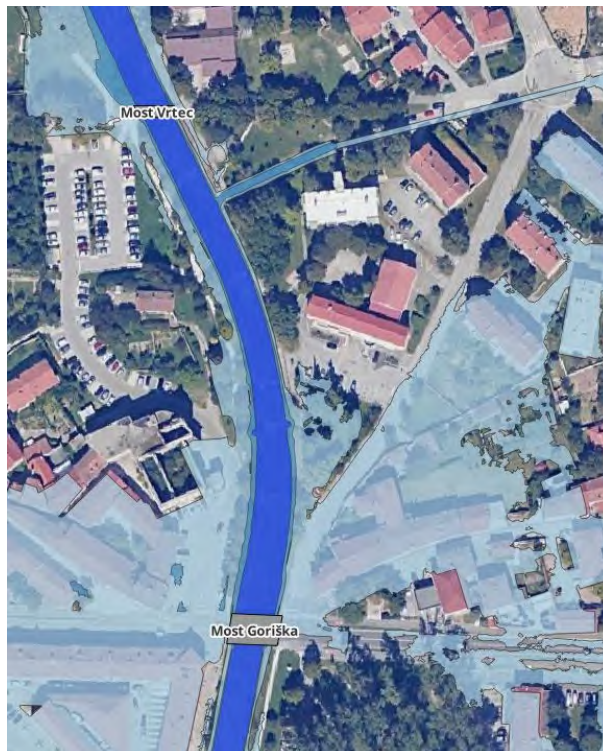
Slika 38: Doseg petstoletnih voda v primeru izvedbe protipoplavnega ukrepa na desnem bregu v območju OPPN
