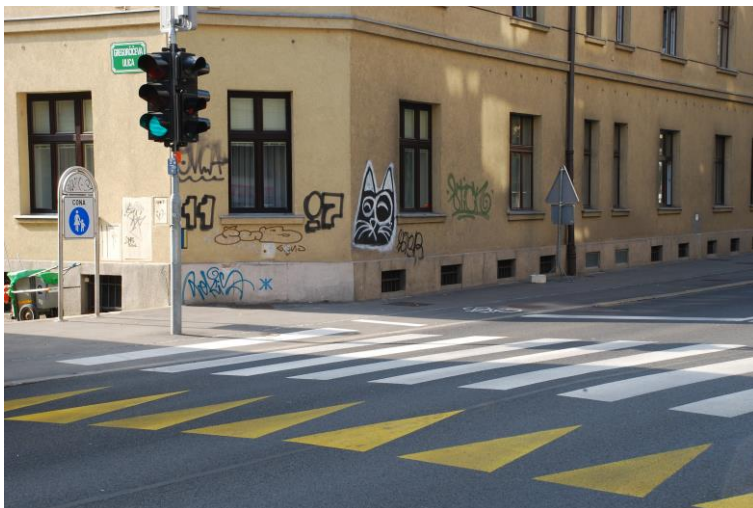
Prehod kod dvignjena ploščad, s semaforjem s kratkim intervalom in tipko, ter odštevalnikom do zelene luči, na Slovenski cesti v Ljubljani
