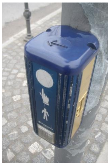
Slika A: Ustrezno opremljen zvočni semafor. Slika B: reliefna puščica na vrhu škatlice semaforja slepi osebi sporoči smer v kateri lahko prečca cesto. Slika C: Na navpični stranici škatlice semaforja lahko slepi otipa postavitev prometnih pasov in dobi občutek o velikosti ceste, ki jo namerava prečkati.
