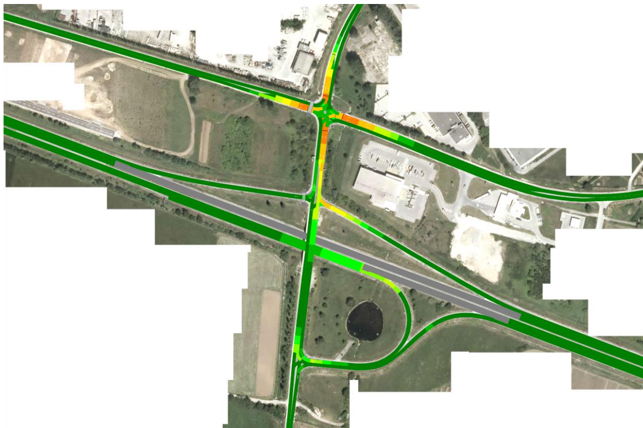
Slika 21: Relativna zamuda na omrežju, obstoječe semaforizirano križišče K1, jutranja konica 2020
