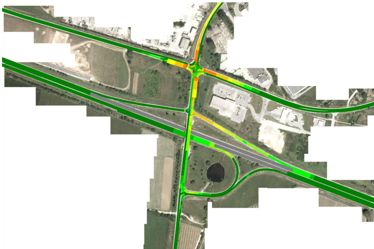
Slika 24: Relativna zamuda na omrežju, modificirano semaforizirano križišče K1, popoldanska konica 2040
