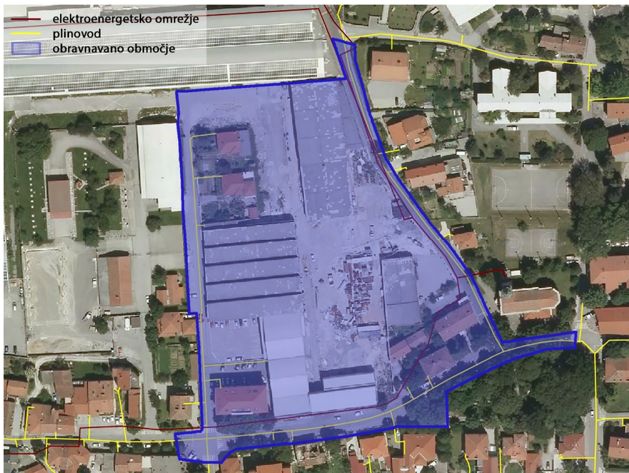
Slika 7: Energetska infrastruktura, vir: https://gis.iobcina.si/gisapp/Default.aspx?a=ajdovscina
